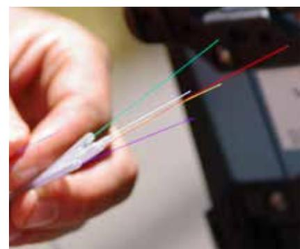
Pour être protégé, le fil de fibre optique **est enrobé de résine, puis d'une gaine qui sera polissée et colorisée**. Ces tubes de fibre sont ensuite disposés en rouleaux de 50 km.
